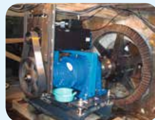
▷ Modernisation de la production d'énergie du moulin avec multiplicateur de vitesse et génératrice de courant
